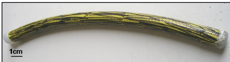
Figure 9. Modèle physique utilisé pour les mesures de température environnementale. Le modèle (35x2cm) est confectionné en tuyau plastique équipé d'un enregistreur automatique de température, rempli d'eau, puis bouché aux deux extrémités.
